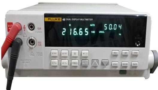
**Los equipos de medición cuentan con un certificado de calibración que respaldan su calidad y confianza; Contamos con 2 instrumentos de contraste marca Fluke 45 DDM los mismos son enviados para ser testeados y certificados periódicamente la empresa certificadora viditec utiliza un instrumento patrón marca Fluke 5500A N° de serie 6450037 cuyos estándares de medida son certificados por Instituto Nacional de Tecnología Industrial (INTI)**
